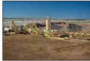
a - Esempio di impianto di desorbimento termico (par.4.3.1 - RT01)
