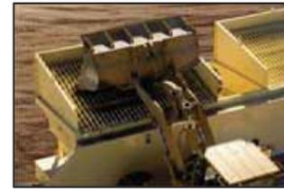
c - Caricamento del terreno - Particolare Tramoggia di carico e griglia a barre (par.4.3.1.1 - RT01)
